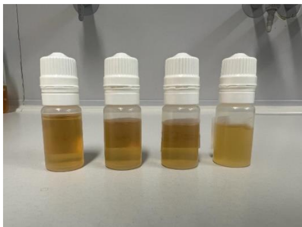
ABBILDUNG 21: Novelia®-Proben während des „tip seal integrity test“. Von links nach rechts: negative Referenz, Probe gelagert bei 4 °C, Probe gelagert bei 23 °C, positive Referenz (trüb).
