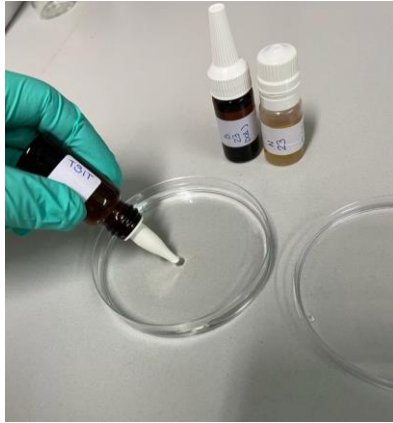
ABBILDUNG 10: Durchführung des „tip seal integrity test“
