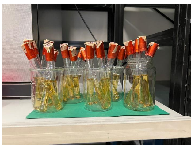
ABBILDUNG 8: Lagerung der Proben in Bechergläsern während Inkubation
