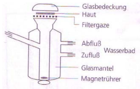
Abb. 3.3.1. Aufbau der Franz-Diffusionszelle [11]
