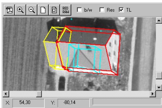
Abb. 44: Kombination dreier Gebäudeprimitive zum einem Gebäudemodell
