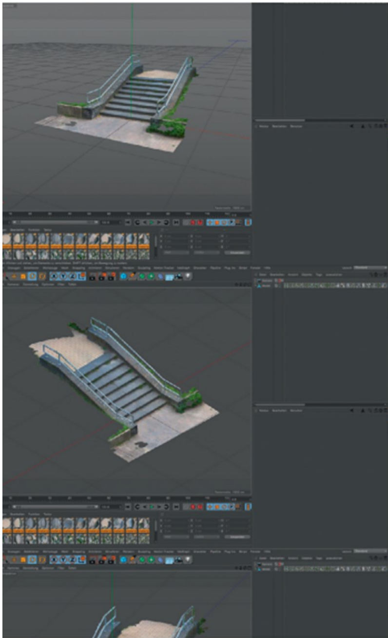
Abb. 6: Die Fotogrammetrie Software wird veranschaulicht. Im oberen Bild ist eine Ansicht zu sehen, wo die Zentralperspektive eingestellt ist und im unteren Bild die Parallelperspektive.
