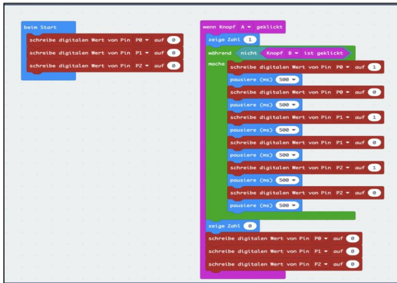
Abbildung 36: Ampelschaltung mit 3 digitalen PINs (eigene Abbildung)
