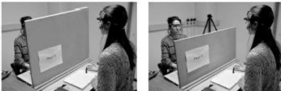
Abbildung 1 Versuchsaufbau bei Kooperation mit blockiertem Blickkontakt (links) und freiem Blickfeld (rechts) für die Proband:innen (Behrens et al., 2020, S. 2).
