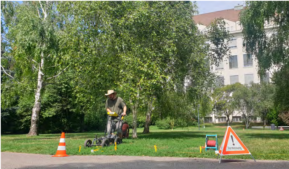
Abbildung 2.3: Der Verfasser bei der Bodenradarmessung auf Teilfläche A am 23.08.2023. Foto: I. Trink.
