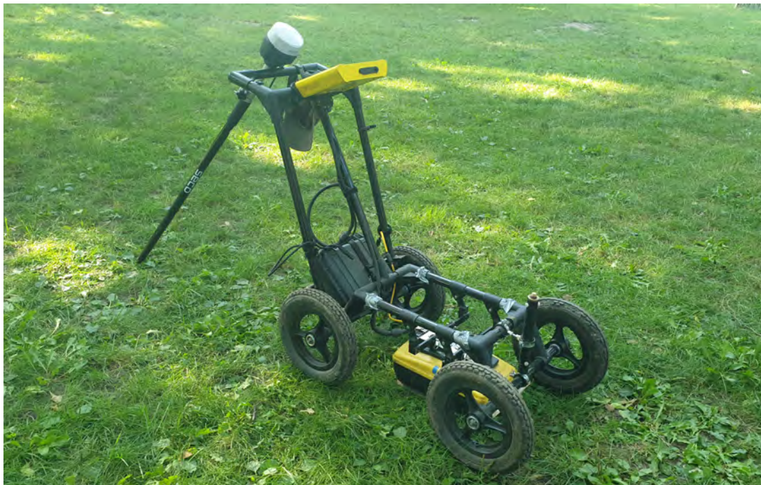
Abbildung 2.1: Das verwendete Sensors & Software Noggin Plus Bodenradarsystem mit einer 500 MHz Antenne. Der zur Georeferenzierung genutzte EMLID REACH RS2 RTK-GNSS Empfänger lehnt an dem Griff des SmartCart . Foto: I. Trinks.
