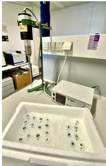
Abbildung 4: Proben in Eisbox mit Anblick auf die Ultraschallsonde (Quelle: Autor)
