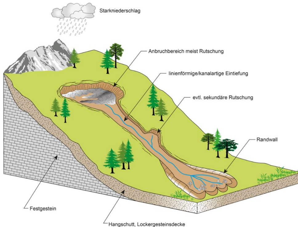
Abbildung 7: Schematisches Blockbild einer Hangmure mit typischen Charakteristika im Gelände; (Quelle: Das geowissenschaftliche Portal für Baden-Württemberg | LGRBwissen, o. J.)
