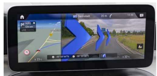
Abbildung 22: AR-Navigation auf einem Display im Auto am Beispiel eines Mercedes GLC verändert nach (Eddy, 2022)
