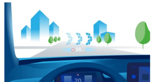
Abbildung 23: schematische Darstellung eines AR-HUD mit Navigationsanweisungen, verändert nach (Volkswagen, kein Datum a)
