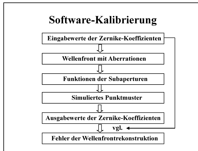
Abb.23 Flowchart-Diagramm zur Veranschaulichung der Software-Kalibrierung
