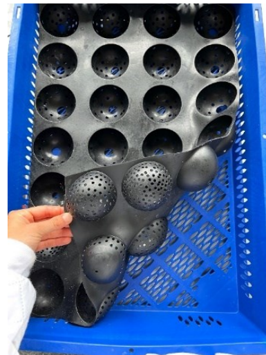
Abbildung 21: Blaue Gitterkiste mit Silikonmatte und verschiedenen großen Löchern für einen Kochtest der Knödel
