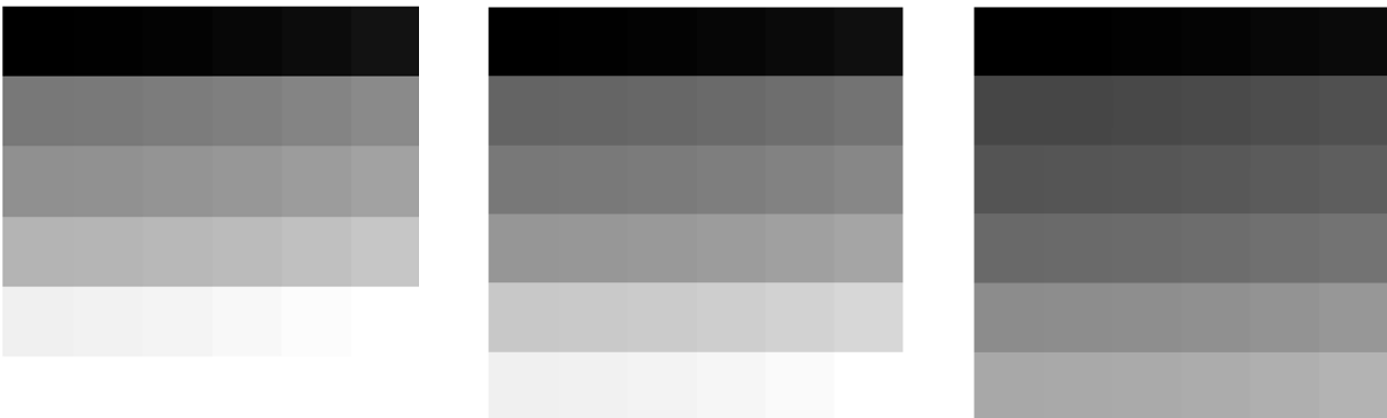
Abbildung 3.12: Erhöhung (links) oder Verringerung (rechts) des Kontrasts des Originals (mitte)
