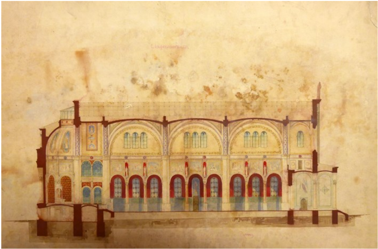
Abbildung 30, Friedrich A. Stache, Projekt Breitenfeld, Schnitt der Längsseite, 1848, schwarze und rote Tusche, koloriert auf Karton, der mit dünner Leinwand hinterlegt ist, 46 x 62,8 cm, reproduziert nach Plänen des Staatsarchives 1030Wien.
