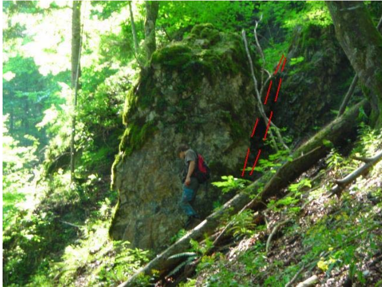
Abb. 18: Hauptdolomit; Critical Layer, Öffnung der Trennfläche durch unterbrochene Linie markiert
