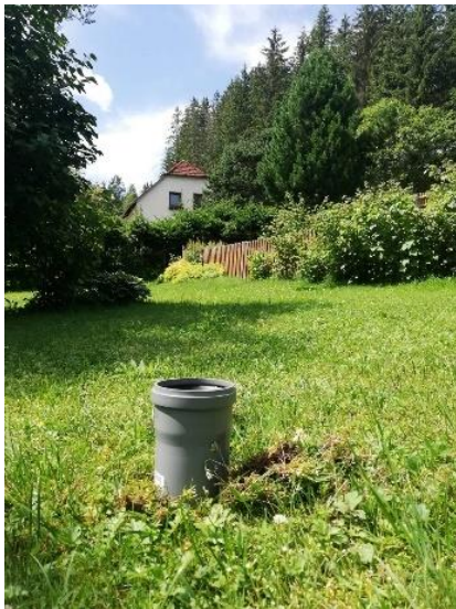
Abb. 6: Infiltrationsmessung mit PVC-Rohr. (c) SCHREINLECHNER, A., 2023.
