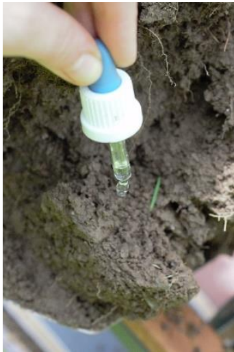
Abb. 17: Karbonat-Test. (c) SCHREINLECHNER, A., 2023.
