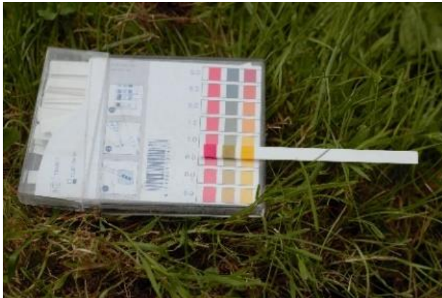
Abb. 13: pH-Wert Wasser. (c) SCHREINLECHNER, A., 2023.
