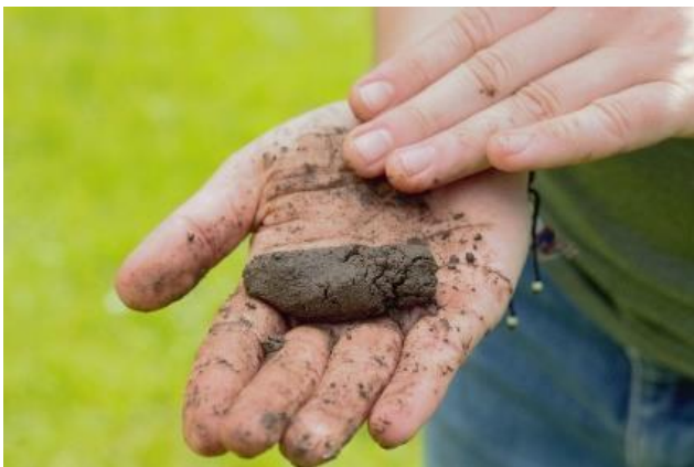
Abb. 10: Fingerprobe. (c) SCHREINLECHNER, A. (2023)
