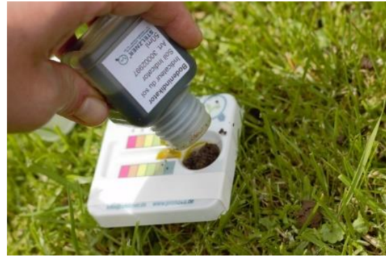
Abb. 15: Indikatorlösung. (c) SCHREINLECHNER, A., 2023.
