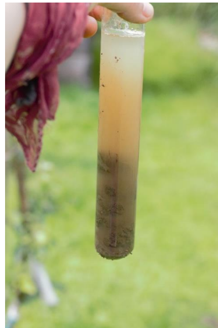
Abb. 12: Trübungsprobe. (c) SCHREINLECHNER, A., 2023.
