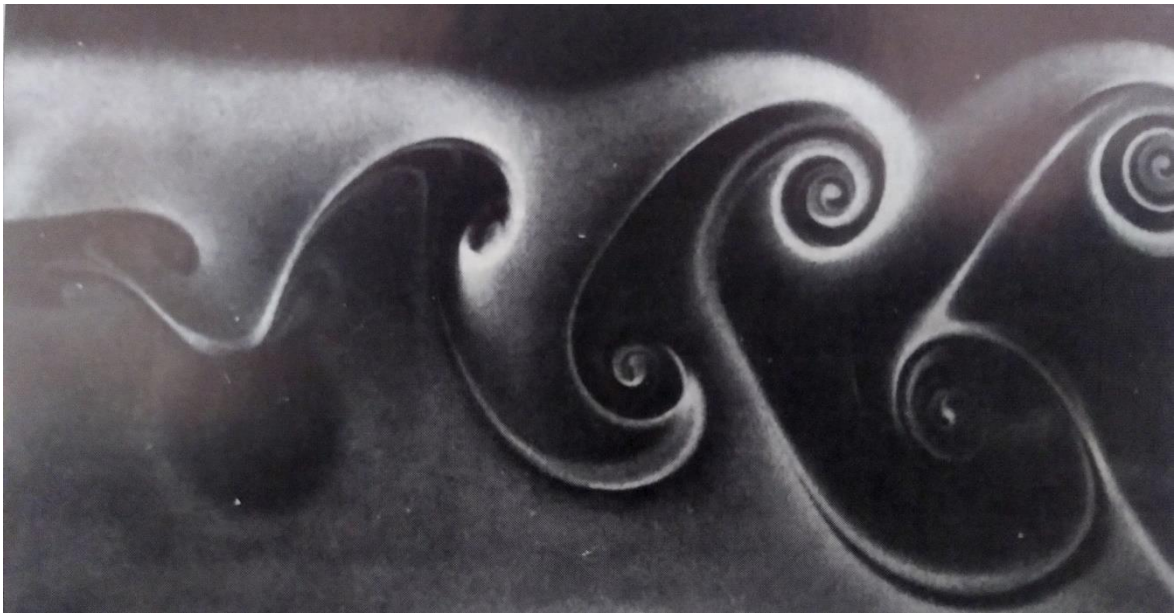
Abbildung 33: Bildung einer Kármán'schen Wirbelstraße hinter einem Kreiszylinder. Rauch wurde der Luftströmung von links nach rechts zur Visualisierung beigelegt (Bäuerle 1997, S. 102).
