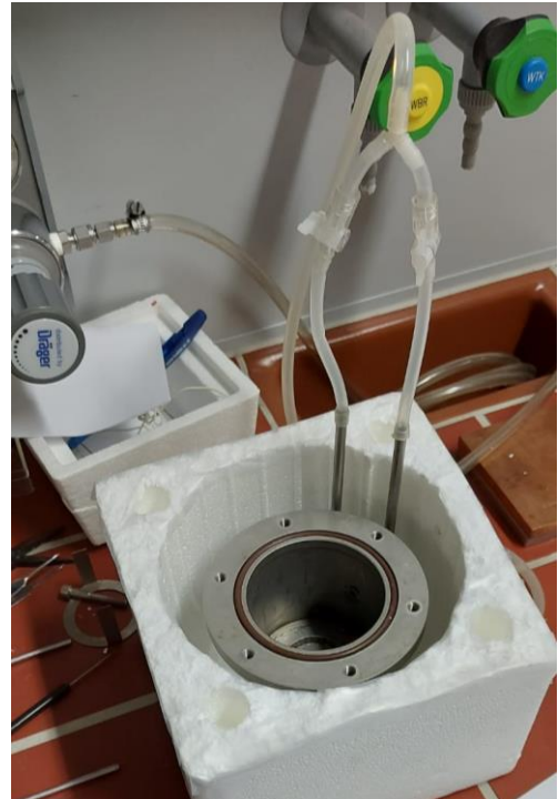
Abbildung 6: Verwendeter Aufbau eines doppelwandigen Gefäßes für das Argon-Laden
