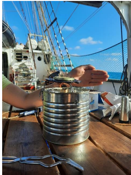
Abbildung 10 Das selbstgebaute Dreibein im Einsatz. Die große Metalldose schützte die Brennerflamme vor Wind und bot Stabilität. Der obere Teil des Dreibeins gewährte Luftzufuhr und war an die Schräglage Dank seiner Drahtkonstruktion gut anpassbar. Die Drahtkonstruktion ist mit der Dose fest und stabil verbunden.
