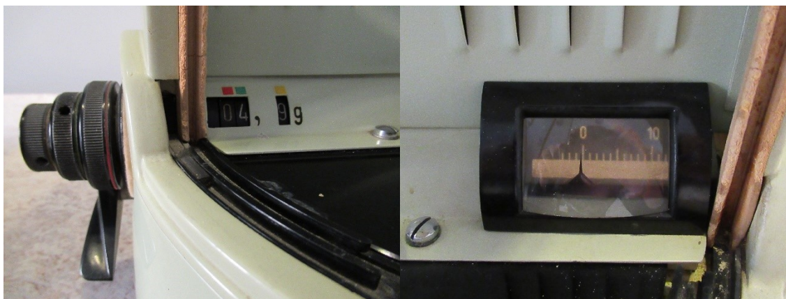
Abb. 24: Sartorius – Selecta Semi-Mikro: Anzeigen
