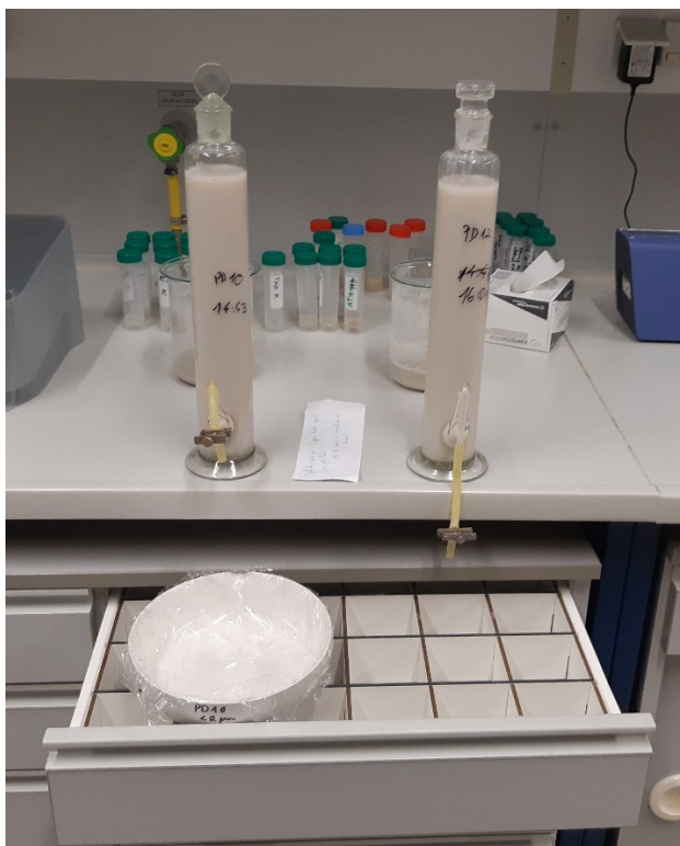
Abbildung 8 Aufbau der Atterberg-Zylinder kurz vor dem Ablassen der <2\mu\text{m} -Fraktion
