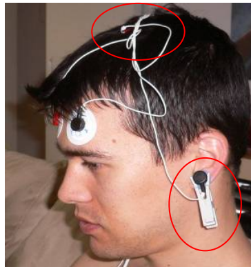
Abbildung 17 – EEG Cz, Ref. li. Ohr, Ground re. Ohr
