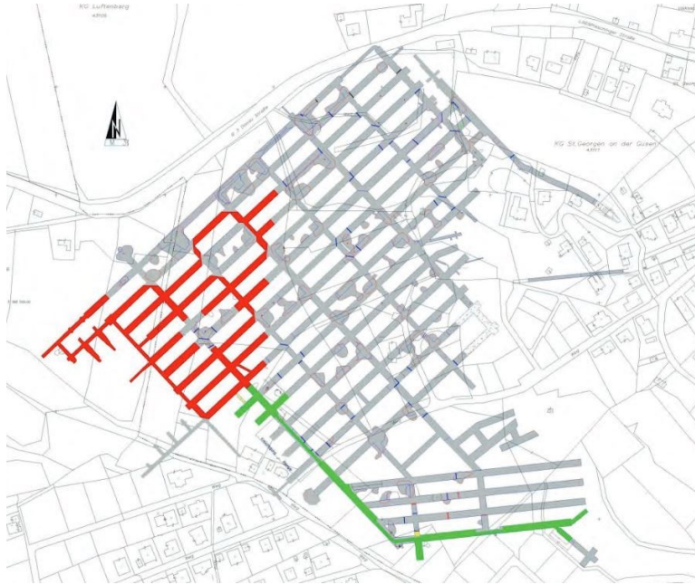
Abbildung 3: Das Stollensystem "Bergkristall" heute, sichtbar ist die Überbauung sowie die aufgefüllten (grau), begehbaren (grün) und nicht begehbaren (rot) Stollen (Quelle: BIG)
