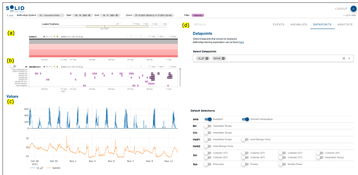
Figure 2: In dieser Masterarbeit wird SunScreen vorgestellt - ein visuelles Interface zur Fehlererkennung und Diagnose bei solarthermischen Anlagen. Es besteht aus vier Hauptbereichen: (a) zeigt alle Ereignisse, die die Anlage zu einer gewissen Zeit beeinflussen (z.B.: Services, oder Fehler) als Gantt-Chart an. (b) zeigt Anomalien an, die von Fehler-Algorithmen erkannt wurden. Die Messwerte ausgewählter Sensoren können in (c) als Zeitreihe angezeigt werden. Im Detail-Panel (d) können mehr Informationen zu den Anlagen-Ereignissen, Anomalien, Messwerten und Annotationen angezeigt werden.
