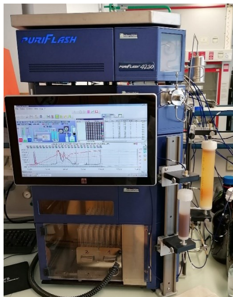
Abbildung 18 Interchim puriFlash® 4250 während der Fraktionssammlung
