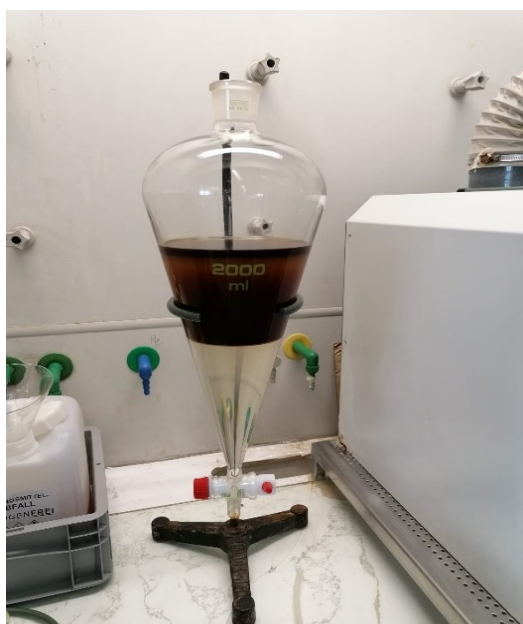
Abbildung 6 Abbildung eines Scheidetrichters nach der Flüssig- Flüssig Extraktion. Zu sehen ist die obere, NaOH-Phase mit beinhalteten Pigmenten und Phenolen und die untere, von Pigmenten und Trametanolsäure befreite DCM-Phase (IO_LS_DCM)
