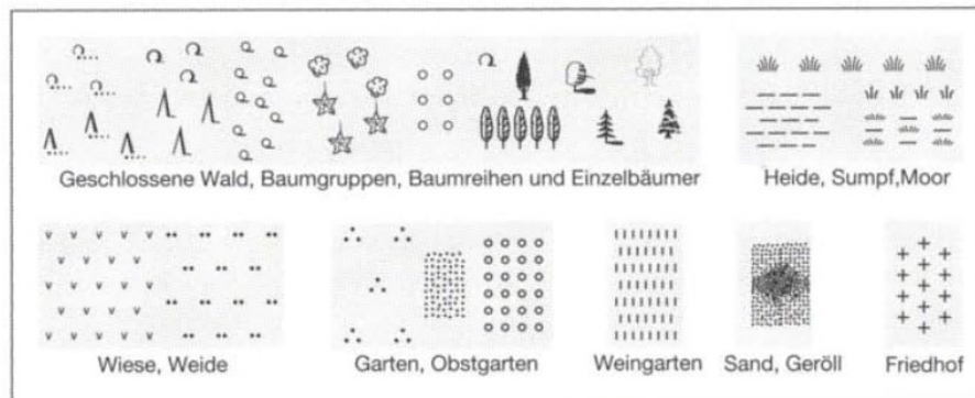
Abbildung 13: Beispiele der Vegetationsdarstellung (HAKE et al. 2002: 425)
