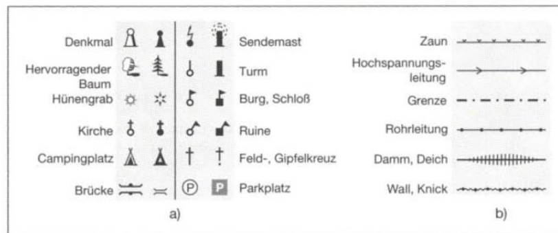
Abbildung 14: Beispiele punktueller und linearer Einzelobjekte (HAKE et al. 2002: 425)
