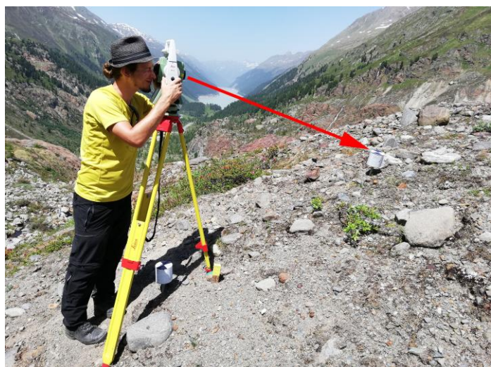
Abb. 7: Tachymetrie im Untersuchungsgebiet (LIEDL 2019)
