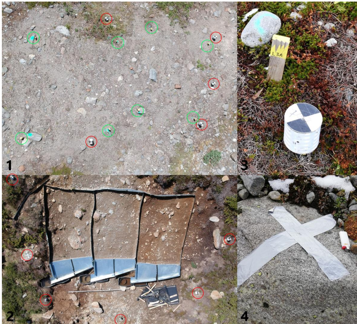
Abb. 6: 1.: Site L3A, 2.: Site S1, 3.: Begrenzungs-Holzpflock und Mobiler GCP, 4.: Bedrock-GCP
