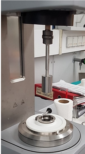
Abbildung 9: Rheometer MCR 302 von Anton Paar mit Doppelspaltzylinder-Messsystem
