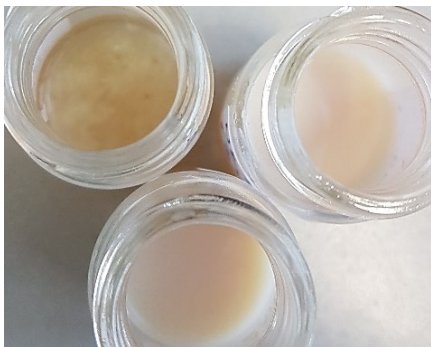
Abbildung 17: NE B m. G. f. Rh.: Verfärbung und Schaumbildung einer Probe, Woche 12
