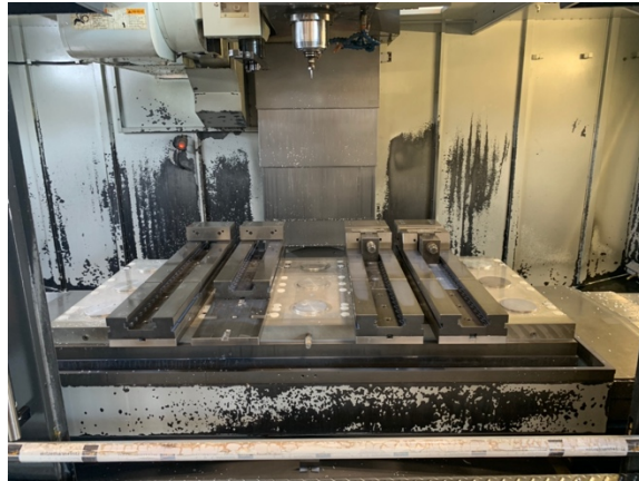
Abb. 17: Schnellspannsystem ‚Spannfix‘ bei w+f
