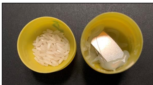
Abbildung: Inhalt des eiförmigen Körpers: Reiskörner und ein magnetisches Metall eingeklebt an einem Ende (eigene Abbildung)
