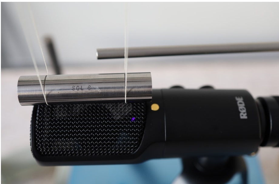
Abbildung 111: Versuchsaufbau mit Stahlzylinder SOL 6
