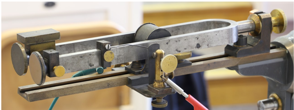
Abbildung 69: Stimmgabel V 72/1 mit Zusatzmassen
