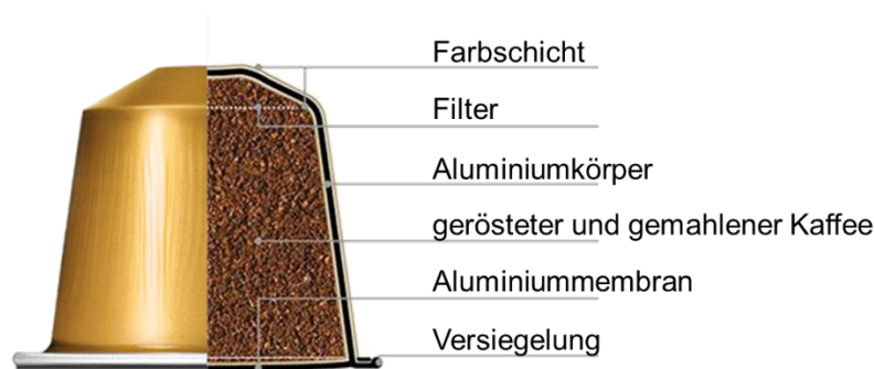
Abbildung 2 Aufbau einer Nespresso Kapsel (Nestlé Nespresso S.A. o.D.c)
