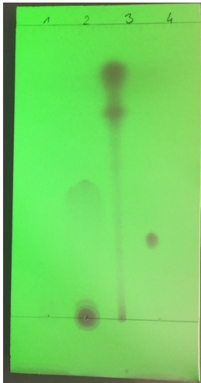
Abbildung 49: DC-Vergleich von AITC-NAC und Edukten Von links nach rechts: \text{NaHCO}_3 , NAC, AITC und AITC-NAC
