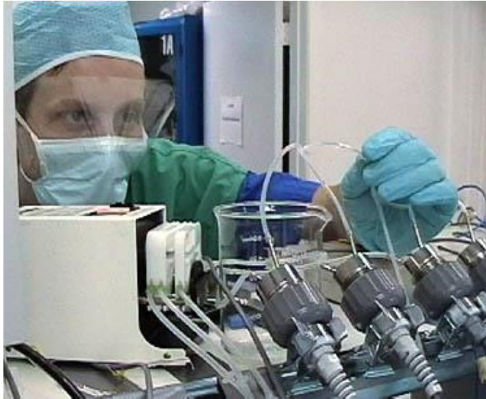
Abb. 7: Ein Techniker überprüft Leitungen, die an elektronische Geräte angeschlossen sind und die Kryoprotektionsmittelkonzentration messen (Refraktometer).
