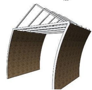
Schemata 11.12: verschlossene, aber nicht ausgesteifte Mittelschiffmauern
