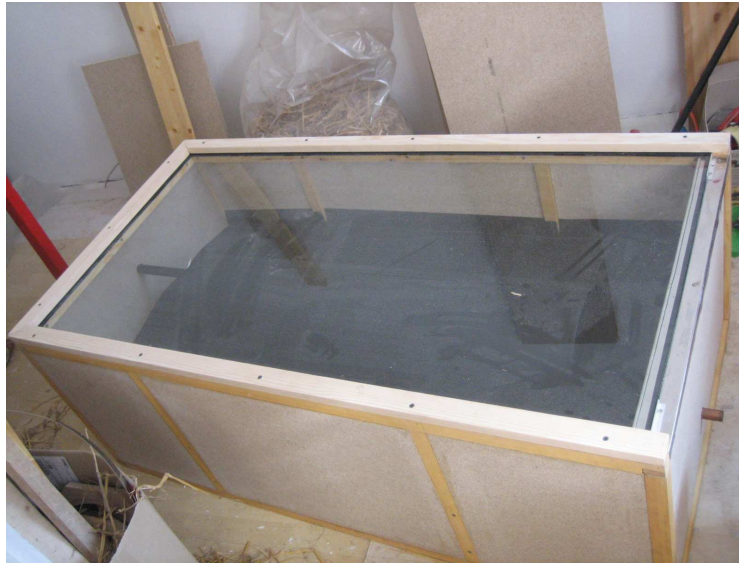
Abbildung 14: Gehäuse mit Glasplatte und integriertem Absorber
