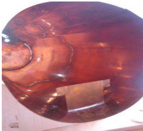
Abbildung 13: Innenansicht des Kupfertanks mit Prallblech
