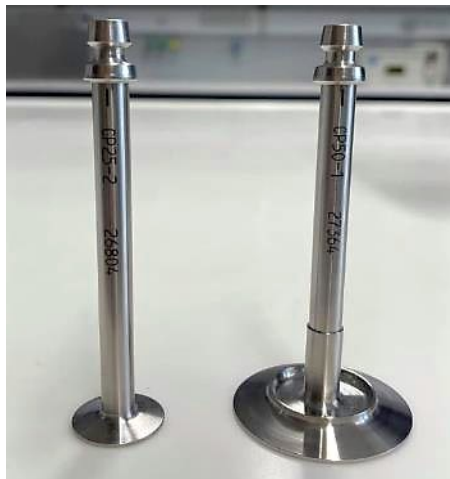
Abbildung 14: Messkörper li: CP-25-2, re: CP 50-1
