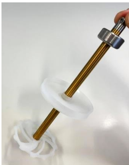
Abbildung 8: verwendete Werkzeugwelle mit Hubboden und Mischscheibe
