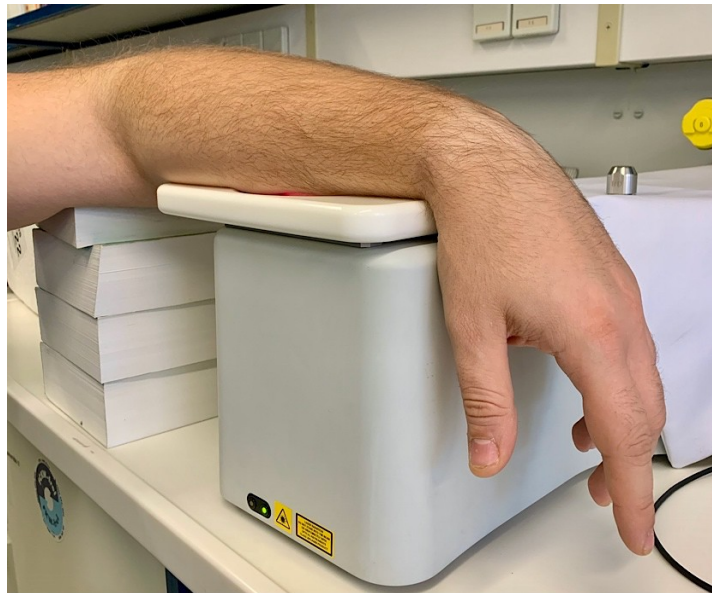
Abbildung 21: Positionierung des Unterarms auf das Messfenster des gen2-SCA
