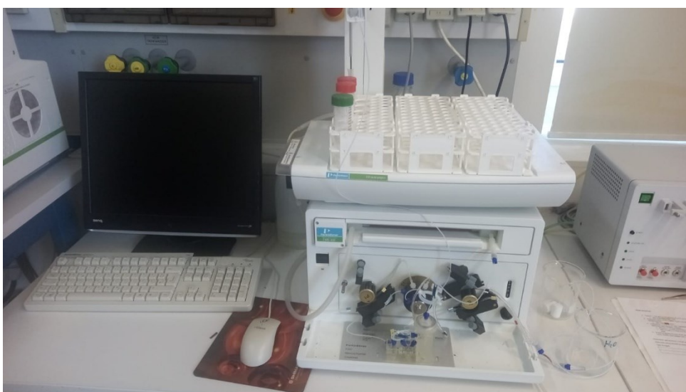
Abbildung 17: Das verwendete CV-AAS Gerät, FIMS 400 Mercury Analysis System
