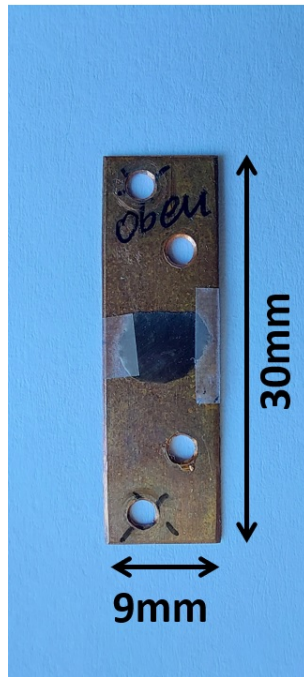
Abbildung 4.2.: \text{Ni}_{58}\text{Al}_{42} -Probe montiert auf einem Probenhalter.
