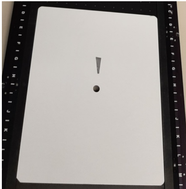
Abbildung A.1.: Röntgenspeicherfolie mit einem aufgeklebten ungleichseitigen Bleidreieck.
