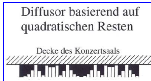
Abbildung 2.4: Quadratic-Residue Diffusor (QRD), auf der Primzahl 17 als Periode beruhend. Derartige Strukturen sind weltweit als „Schroeder-Diffusoren“ bekannt und auch in der Göttinger Stadthalle zu finden. Die Wahl von 17 als Periode erlaubt die effiziente Schallstreuung von vier musikalischen Oktaven (Schroeder, 2008, S. 161).
