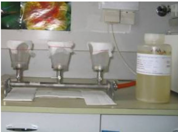
Abb. 9: Filtration der Wasserproben mit einer Wasserstrahlpumpe.
