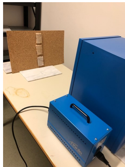
Abbildung 39: Hautproben vor der Bestrahlung (links) + Versuchsaufbau mit SOL 500 (rechts)
