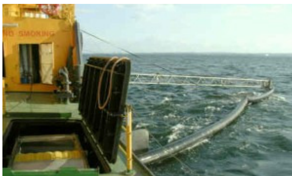
Zdjęcie 9. Statek do zwalczania zanieczyszczeń olejowych
