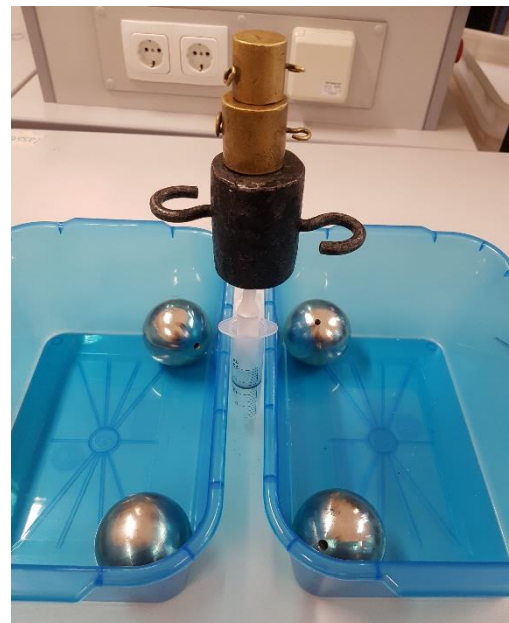
Abb. b.5: Aufbau zur Messung der Gleitreibungskraft zwischen Spritzenkolben und Zylinder.
