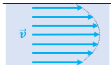
Abb. b.2: Geschwindigkeitsverteilung laminarer Strömungen im Rohr (verändert nach Schlichting, 2006).
