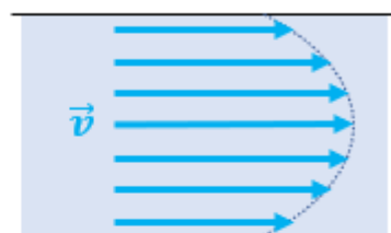
Abb. b.2: Geschwindigkeitsverteilung laminarer Strömungen im Rohr (verändert nach Schlichting, 2006).
