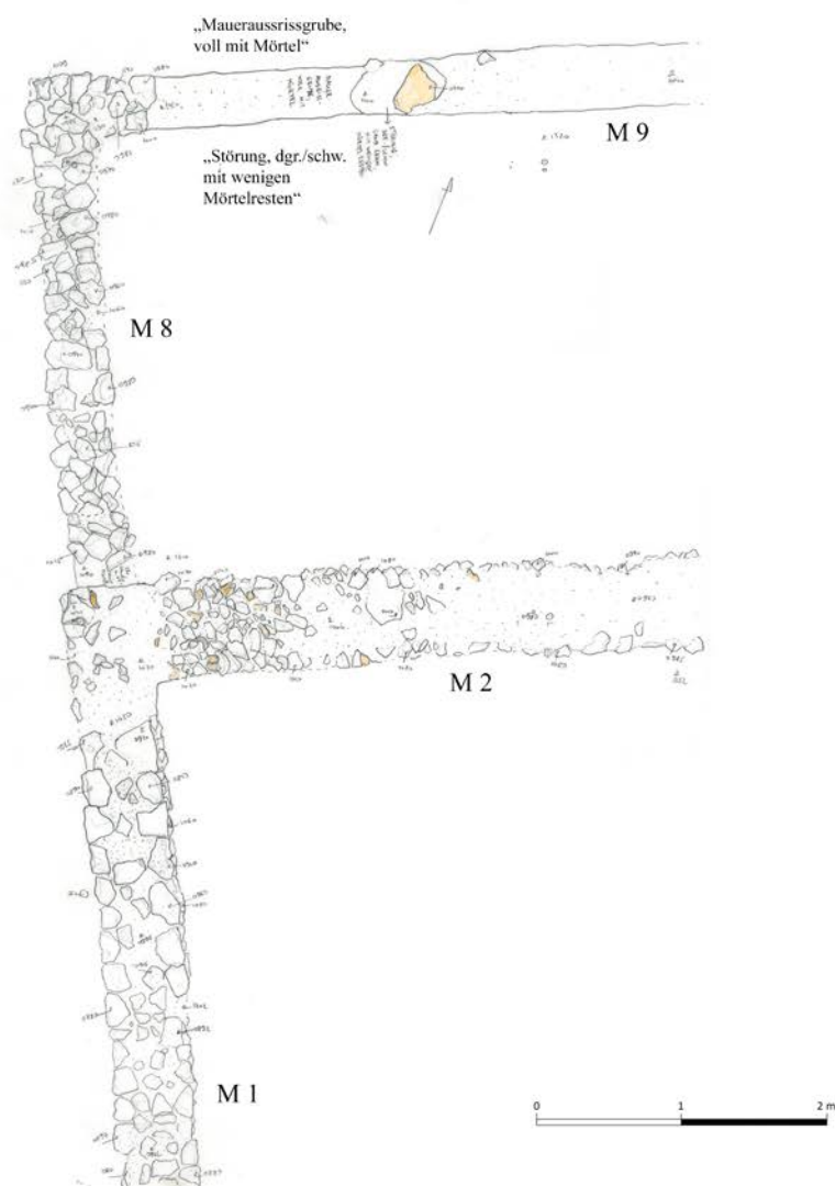
Taf. 3. 2. Detail Befunddokumentation Obj. 1636, Mauerecke 1 - 2, Anschluss Mauer 8 (Blatt 281, BDA).
