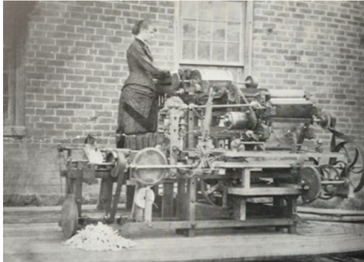
Abb 2: Eine der ersten Strangzigarettenmaschinen, um 1880. Quelle: Trost (1984) Zur allgemeinen Erleichterung, S. 146
