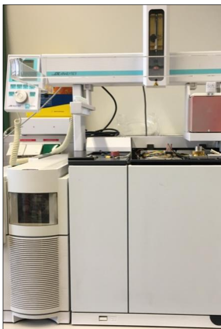
Abb. 6: Gaschromatograph mit Probengeber für die SPME im Institut für Tierernährung und Funktionelle Pflanzenstoffe
