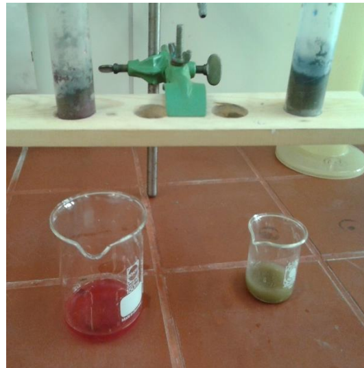
Abbildung 93: Versuchsaufbau: präparierte Spritzen mit Fichtenwaldboden - links mit Säurefuchsin - rechts mit Methylenblau überschichtet
