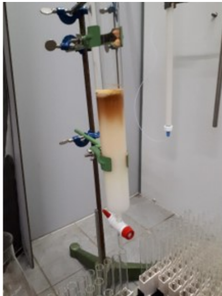
Abbildung 3: Säulenchromatographie der Wasserfraktion
